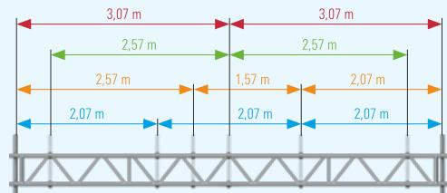
Les poutres en treillis sont utilisées pour la réalisation de travées et de renforts lors de la construction d'échafaudages.
