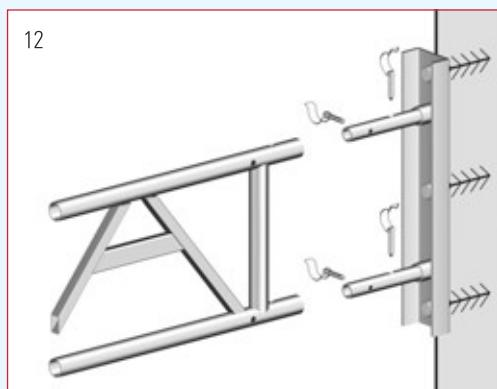
Les goujons boulonnés sont utilisés pour fixer les montants aux moises ou aux poutres.
