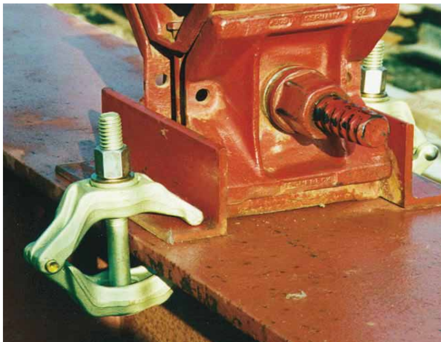
Bevestiging met universele liggerklem, klemwijdte 16 - 70 mm.
