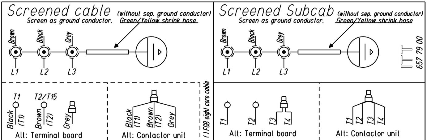
**50/60 Hz 3~, SUBCAB®/SUBCAB® AWG/abgeschirmtes Kabel
