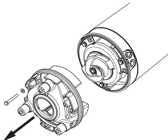
Die Hülsenschraube in Gegenuhreigersinn drehen, bis sich das Laufrad von der Welle gelöst hat. Dazu einen 8 mm Innensechskant mit einer Länge von mindestens 100 mm verwenden.
