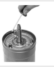
23. Remove the rotor unit.
