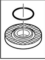
In de opnameflens **8** is rondom de centreerkraag een kunststof onderdeel (O-ring) ingezet. **Als de O-ring ontbreekt of beschadigd is**, moet deze beslist worden vervangen (zaaknummer 1 600 210 039), voordat de opnameflens **8** gemonteerd wordt.
