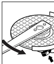
Un écrou de serrage rapide non endommagé qui a été correctement fixé peut être desserré à la main en tournant l'anneau moleté dans le sens inverse des aiguilles d'une montre.
