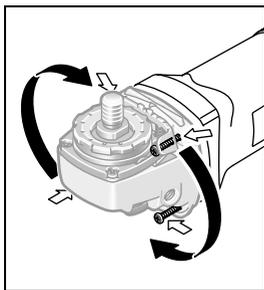
Il est possible de tourner la tête d'engrenage par étapes de  $90^\circ$ . Ceci permet de mettre l'interrupteur Marche/Arrêt dans une position de manient favorable à des utilisations spécifiques, p. ex. pour des travaux de
