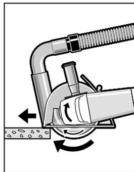
Schakel het elektrische gereedschap in en plaats het met het voorste deel van de geleidingslede op het werkstuk. Duw het elektrische gereedschap verder met een matige voorwaartse beweging, aangepast aan het te bewerken materiaal.
