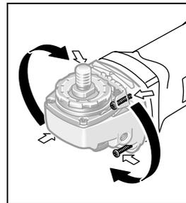
Sie können den Getriebekopf in 90°-Schritten drehen. Dadurch kann der Ein-/Auswechsler für besondere Arbeitsfälle in eine günstigere Handhabungsposition gebracht werden, z. B. für Trennarbeiten mit der Absaughaube mit Führungsschlitten **20**/Trennschleifständer oder für Linkshänder.
