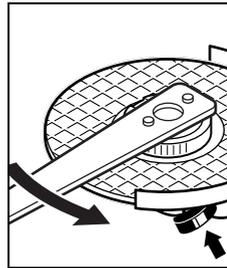
Een op de juiste manier bevestigde en onbeschadigde snelspanmoer kunt u losdraaien door de kartelring tegen de wijzers van de klok in met de hand los te draaien.
