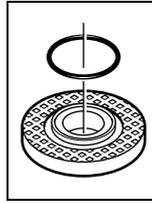
Im Aufnahme­flansch **8** ist um den Zentrierbund ein Kunststoffteil (O-Ring) eingesetzt. **Fehlt der O-Ring oder ist er beschädigt**, muss er unbedingt ersetzt werden (Sachnummer 1 600 210 039), bevor der Aufnahme­flansch **8** montiert wird.
