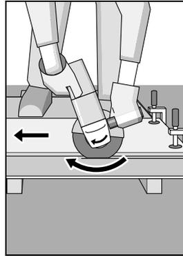
Met het elektrische gereedschap moet altijd tegenlopend worden geslepen. Anders bestaat het gevaar dat de machine **ongecontroleerd** uit de zaaglijn wordt geduwd.
