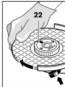
Afin de bloquer la broche de ponçage, appuyez sur la touche de blocage de la broche **22**. Afin de serrer l'écrou de serrage rapide, tournez fortement la meule dans le sens des aiguilles d'une montre.
