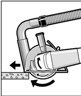
Mettez l'outil électroportatif en marche et positionnez-le avec la partie avant du chariot de guidage sur la pièce à travailler. Travaillez en appliquant une vitesse d'avance modérée adaptée au matériau.
