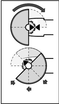
Setzen Sie die Schutzhaube **12** der Abbildung entsprechend auf den Spindelhals. Die Dreiecksmarkierungen der Schutzhaube müssen mit den entsprechenden Markierungen am Getriebekopf übereinstimmen.
