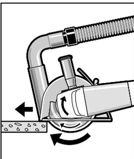
Schalten Sie das Elektrowerkzeug ein und setzen Sie es mit dem vorderen Teil des Führungsschlittens auf das Werkstück. Schieben Sie das Elektrowerkzeug mit mäßigem, dem zu bearbeitenden Material angepassten Vorschub.
