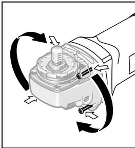
U kunt de machinekop in stappen van 90° draaien. Daardoor kunt u de aan/uit-schakelaar voor bijzondere werkzaamheden in een gunstige bedieningspositie brengen, bijvoorbeeld voor doorslijpwerkzaamheden met de
