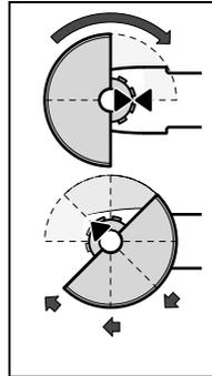
Monter le capot de protection **12** sur le col de la broche conformément à la figure. Les marques triangulaires se trouvant sur le capot de protection doivent coïncider avec les marquages correspondants de la tête d'engrenage.
