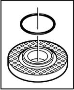
Dans la bride de fixation **8**, il y a une pièce en matière plastique (rondelle élastique) se trouvant autour de l'ergot de centrage. **Au cas où cette rondelle élastique ferait défaut ou qu'elle serait endommagée, il faut absolument la rem-**
