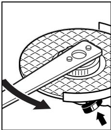
Eine ordnungsgemäß befestigte, unbeschädigte Schnellspannmutter können Sie durch Drehen des Rändelringes entgegen dem Uhrzeigersinn von Hand lösen.
